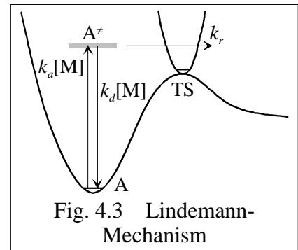
Fig. 4.3 Lindemann-Mechanism
