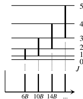
回転ラマン散乱スペクトル
